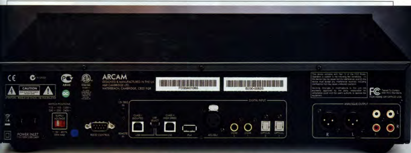
Sul pannello posteriore si vedono nella parte centrale le due prese USB con il relativo selettore, la presa per l'iPod e le connessioni audio digitali coassiali, ottiche e bilanciate. Sulla destra sono invece collocate le uscite analogiche bilanciate e sbilanciate.
